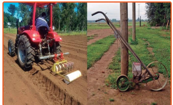
Figura 3. Sembradoras mecánicas (adosada al tractor y manual) para semillas pequeñas de hortalizas
